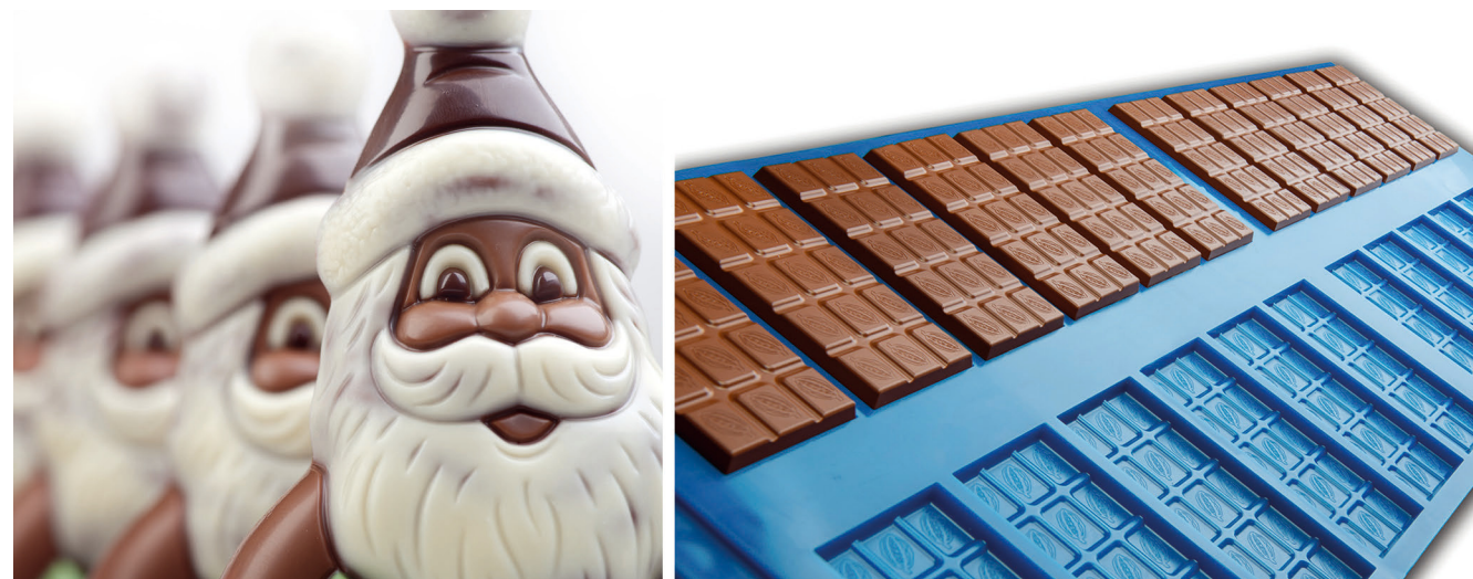
Schokoladefiguren oder -tafeln werden mithilfe von Formen hergestellt, in denen sich bei starker Beanspruchung Risse bilden können. Datenlogger können dabei unterstützen, kritische Parameter im Verarbeitungsprozess zu identifizieren © Hans Brunner GmbH
